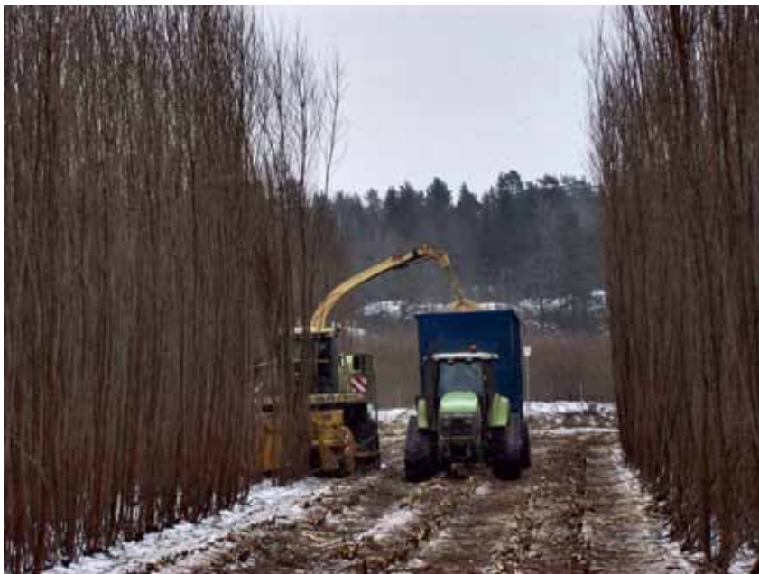
Skörd, direktflisning och lastning av följeekpage. Foto Janne Pettersson
